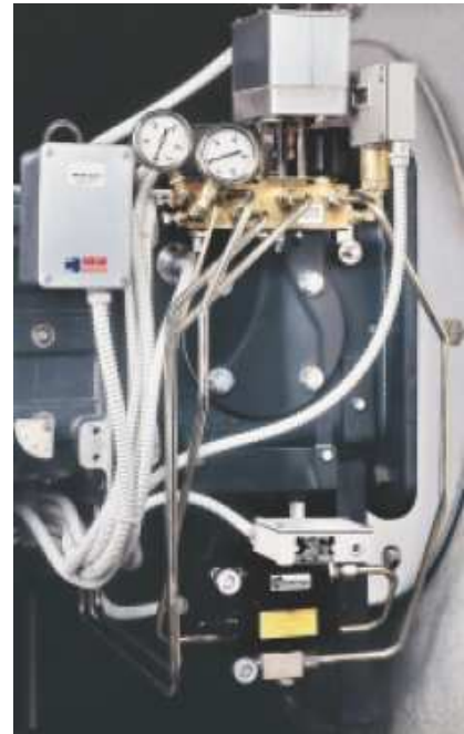
Příklad hydraulického obvodu hořáku MB 4 LE
